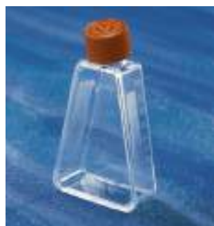
3056 Frasco Triangular de 25 cm 2 com Tampa Ventilada
